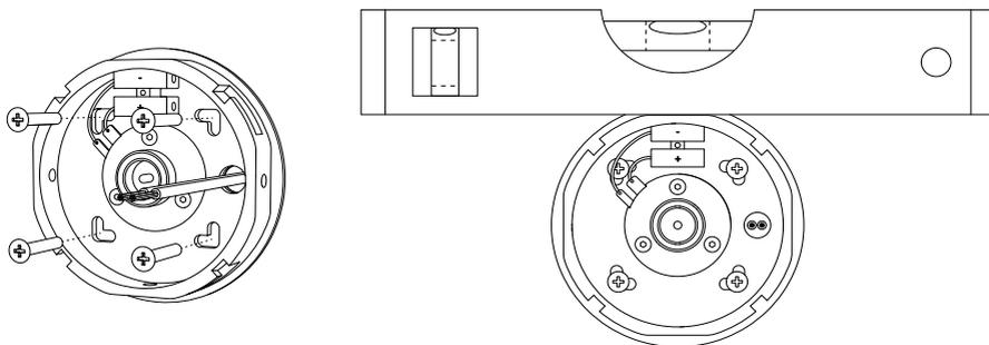
**3.2.3** Connecter les câbles à l'extrémité libre de la pince à ressort. Insérer la pince dans le support de montage, dans la goupille appropriée.
