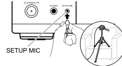
Pour mettre un microphone de configuration d'enceinte sur un trépied, consultez l'illustration en le mettant en place.
