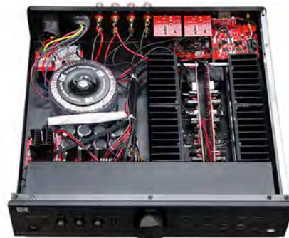
L'intégré stéréophonique EX-242 a été conçu dans un esprit audiophile afin de garantir à l'amateur de haute-fidélité une restitution fidèle de ses musiques préférées. Il délivre une puissance de 2x90W RMS sous 8Ω, et grâce à son alimentation ultra performante, 2x140W sous 4Ω.
