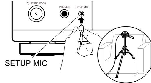
Pour installer un microphone de configuration d'enceinte sur un trépied, consultez l'illustration.
