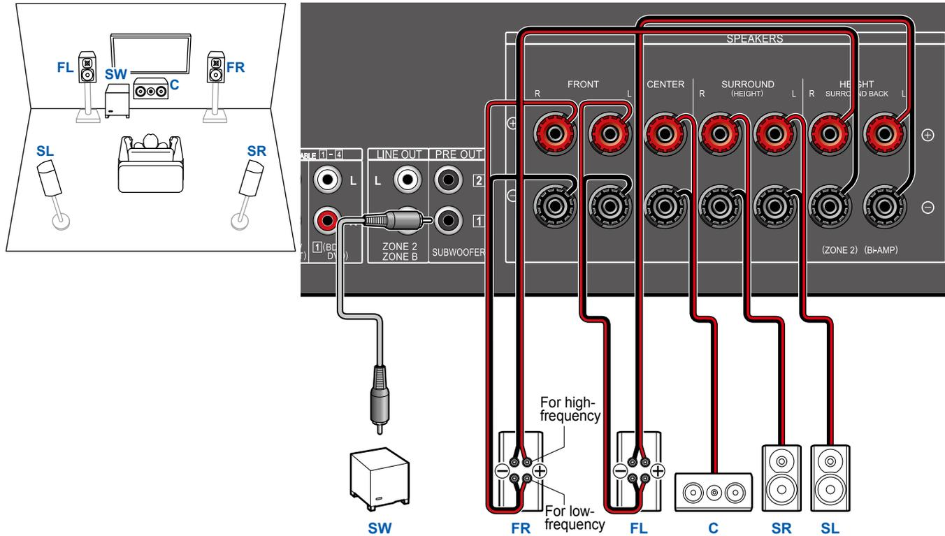
Assurez-vous de retirer le cavalier raccordant les prises des graves et les prises des aigus des enceintes qui prennent en charge la bi-amplification. Consultez également le mode d'emploi de vos enceintes.
