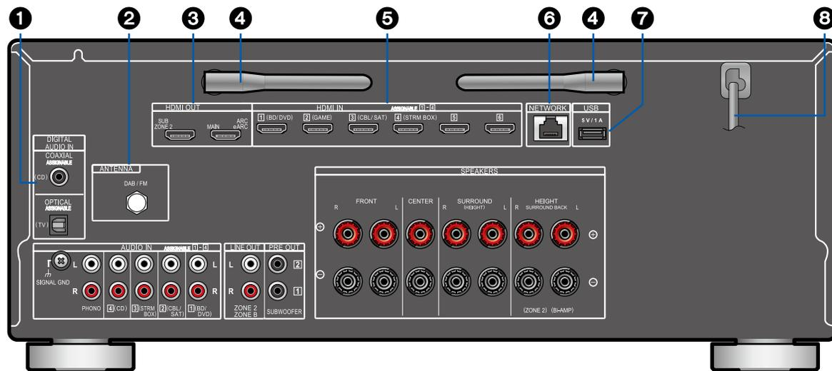
**1. Prises DIGITAL AUDIO IN OPTICAL/ COAXIAL :** Permet l'entrée des signaux audio numérique composante TV ou AV avec un câble optonumérique ou un câble coaxial numérique.
