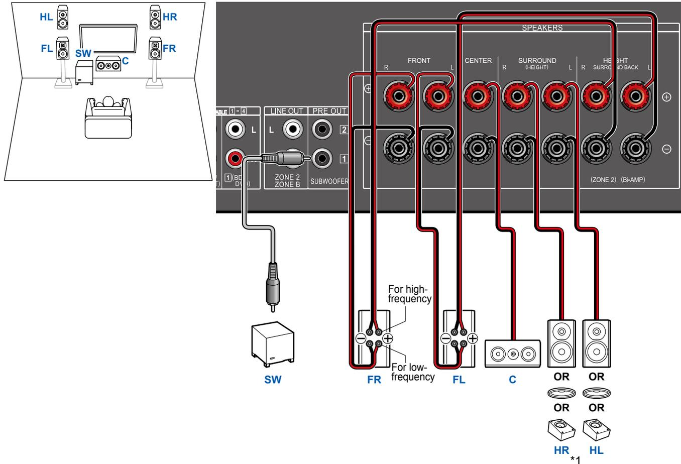
Assurez-vous de retirer le cavalier raccordant les prises des graves et les prises des aigus des enceintes qui prennent en charge la bi-amplification. Consultez également le mode d'emploi de vos enceintes.
