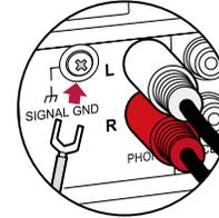
Si la platine tourne-disque a un fil de mise à la terre, branchez-le à la borne SIGNAL GND de cet appareil.
