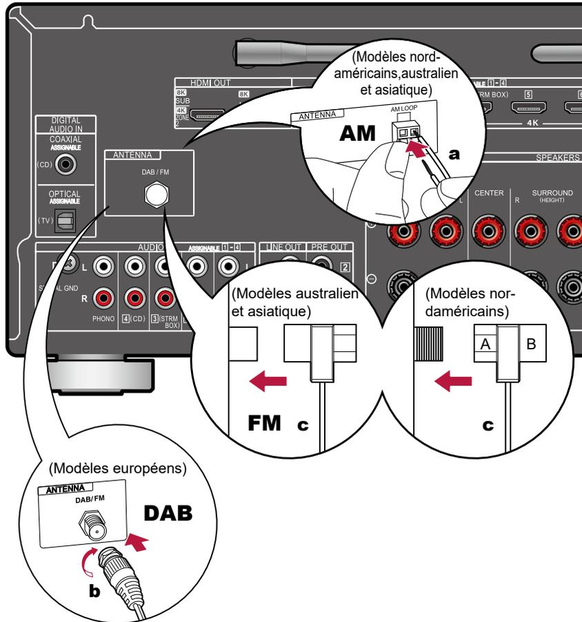
**a** Antenne cadre AM, **b** Antenne DAB/FM, **c** Antenne FM intérieure
