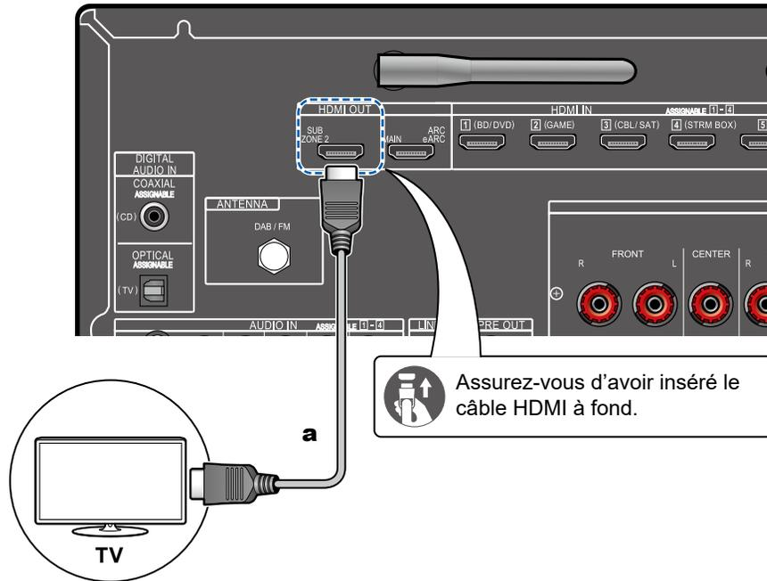
Lorsqu'un disque Blu-ray est lu dans la pièce principale (là où cet appareil est situé), vous pouvez lire l'audio et la vidéo du même lecteur de disque Blu-ray ou d'un autre appareil AV sur le téléviseur équipé d'une prise HDMI IN dans une autre pièce (ZONE 2). Il est à noter que seuls les périphériques raccordés aux prises HDMI IN1 à IN3 peuvent être lus sur le téléviseur situé dans une pièce différente.
