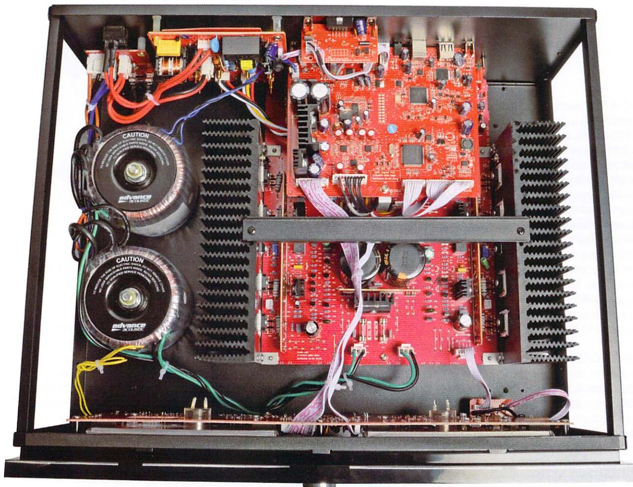
L'intérieur du X-125 profite du changement d'usine pour rationaliser l'implantation des circuits : il n'y a plus, par exemple, qu'un seul DAC gérant toutes les entrées numériques. On aperçoit le double push-pull de transistors de puissance par canal.
