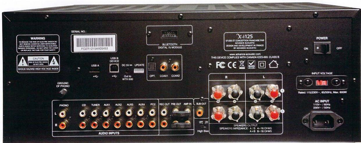
La tradition Advance Acoustic est respectée sur le X-i125, au vu du nombre des entrées analogiques et numériques. La clé optionnelle du Bluetooth se branche sur un connecteur de type HE-10, constituant une entrée supplémentaire.
