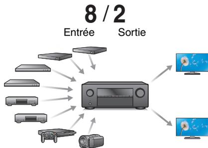
Cet appareil est équipé de 8 entrées HDMI et de 2 sorties HDMI permettant la connexion à divers appareils compatibles HDMI tels que des lecteurs Blu-ray Disc, des consoles de jeux et des caméscopes vidéo HD. Cet appareil est équipé de deux sorties moniteur, ce qui vous permet de projeter la même image en même temps à l'aide de cet appareil.
