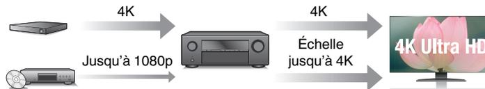
Cet appareil est équipé d'une fonction de vidéo ascendante 4K qui permet à la vidéo SD (définition standard) d'être émise en résolution HDMI à 4K (3 840 × 2 160 pixels). Cette fonction permet à l'appareil d'être connecté à un téléviseur à l'aide d'un simple câble HDMI, et de produire des images en haute définition pour n'importe quelle source vidéo.
