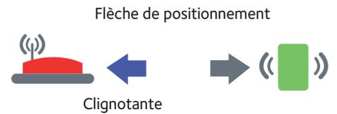
La flèche de positionnement clignote pour indiquer qu'il faut rapprocher le répéteur du router/modem ou du client sans fil afin d'avoir de meilleure performance
