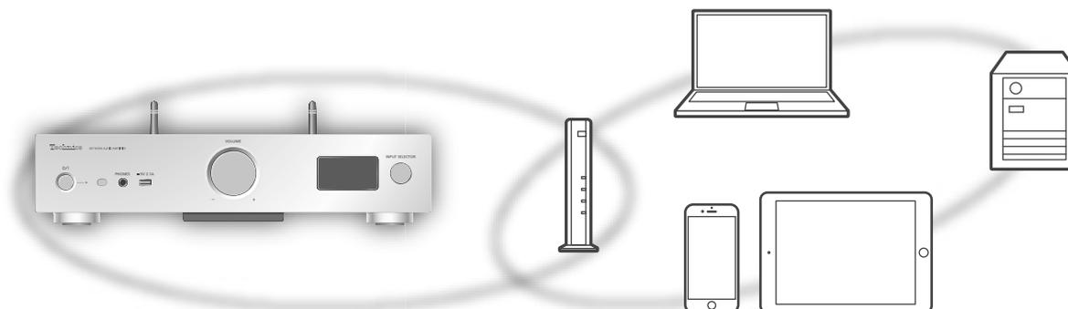
Ce système peut être connecté à un routeur à l'aide d'un câble réseau ou du Wi-Fi® intégré. Pour obtenir une connexion au réseau stable, une connexion LAN filaire est préférable.
