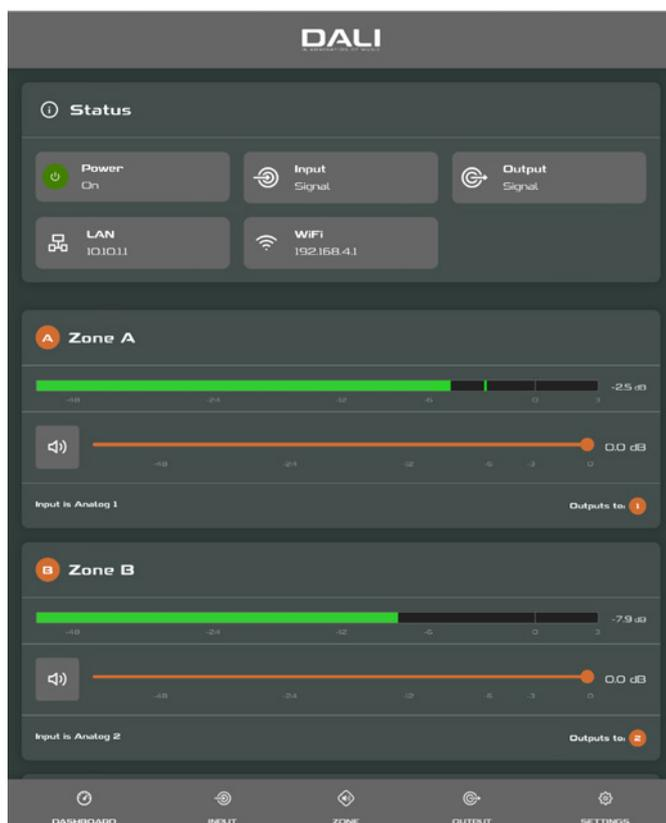
Le **Dashboard** affiche l'état de l'amplificateur, les zones de sortie et les onglets du menu de configuration. Il permet également un accès immédiat au contrôle du volume. Les fonctions avancées disponibles sous chaque onglet du menu de configuration sont décrites dans les paragraphes suivants.
