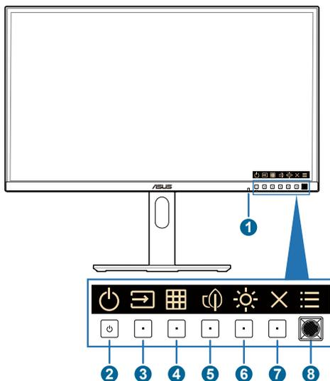
1. Capteur de lumière : Ce capteur est utilisé pour détecter le changement de luminosité ambiante.
