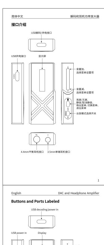
●多功能键: ●音量加键: 短按一次音量加一级,长按音量连续加,在设置菜单界面为向上翻页。 ●台放模式开关: 输出台放般的推力。 菜单设置说明
