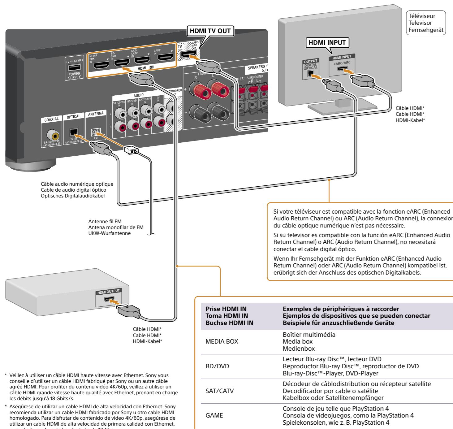
\* Veuillez à utiliser un câble HDMI haute vitesse avec Ethernet. Sony vous conseille d'utiliser un câble HDMI fabriqué par Sony ou un autre câble agréé HDMI. Pour profiter du contenu vidéo 4K/60p, veillez à utiliser un câble HDMI grande vitesse haute qualité avec Ethernet, prenant en charge les débits jusqu'à 18 Gbit/s.
